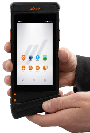
Abb. 37: Untere Logistikschutzkappe abnehmen
