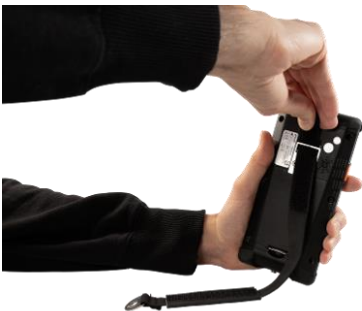
Abb. 6: Halteband durch Haltebandeinhängung ziehen
