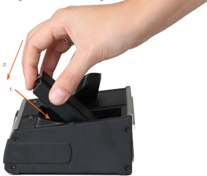
Abb. 11: Ersatzakku in die Dockingstation einlegen
