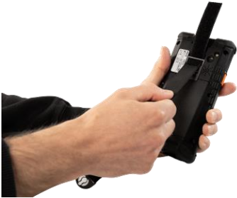
Abbildung 6: Halteband nach unten herausziehen
