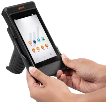
Abb. 31: M2Griff5/M2Griff5 SE vom M2Smart®SE abnehmen (1/2)
