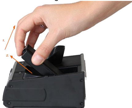
Abb. 12: Ersatzakku aus der Dockingstation entnehmen
