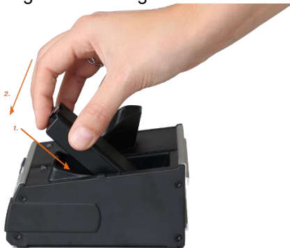
Abbildung 12: Ersatzakku in die Dockingstation einlegen
