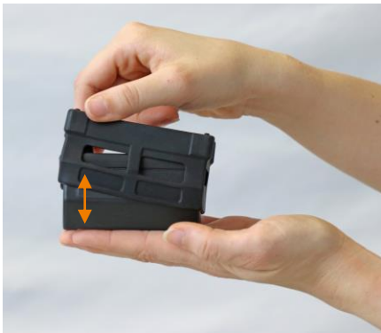
Abb. 42: M2Longrange Schutzkappe anbringen
