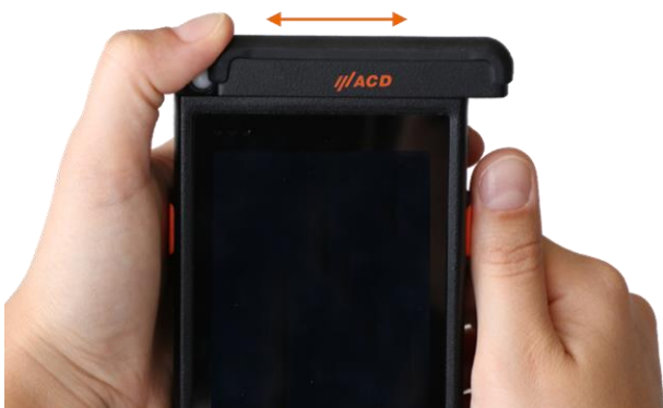
Abbildung 24: Anbringen und Abnehmen des oberen Aufsteckmoduls
