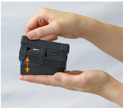
Abb. 43: M2Longrange Schutzkappe abnehmen
