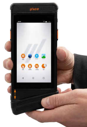
Abbildung 36: Untere Logistikschutzkappe anbringen
