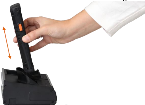
Abb. 10: Mobiler Handheld Computer in die Dockingstation einlegen und entnehmen
