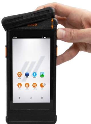
Abbildung 37: Obere Logistikschutzkappe abnehmen
