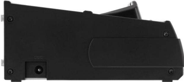
Abb. 19: Schnittstellen der DS2Battery
