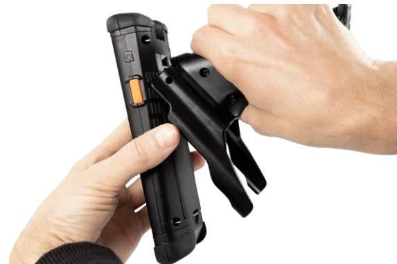
Abb. 32: M2Griff5/M2Griff5 SE vom M2Smart®SE abnehmen (2/2)
