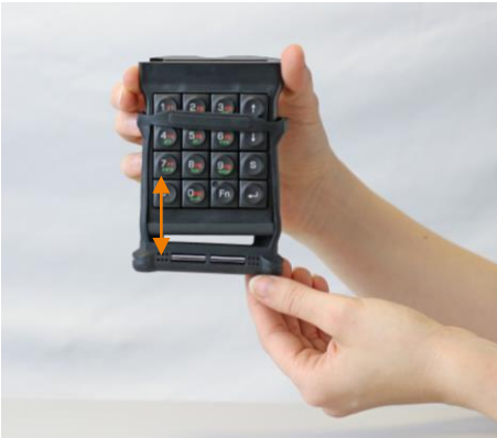
Abb. 39: M2Key16 Logistik Schutzkappe anbringen
