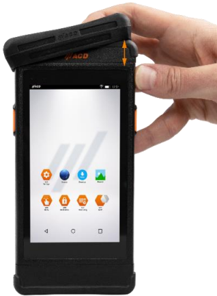
Abbildung 35: Obere Logistikschutzkappe anbringen
