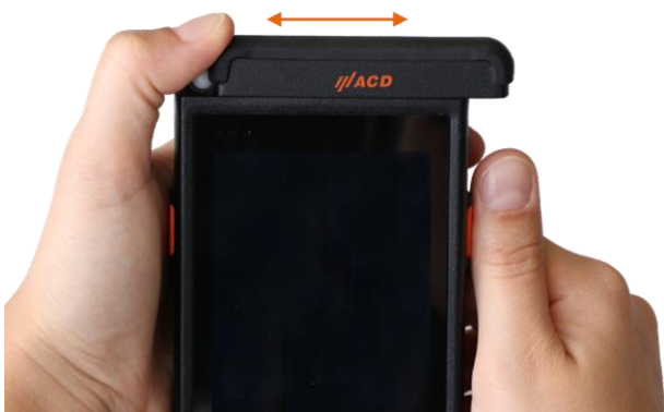
Abb. 23: Anbringen und Abnehmen des oberen Aufsteckmoduls
