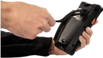
Abb. 3: Klettverschluss des Haltebandes öffnen
