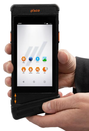
Abbildung 38: Untere Logistikschutzkappe abnehmen
