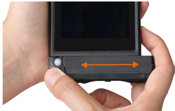
Abbildung 25: Anbringen und Abnehmen des unteren Aufsteckmoduls
