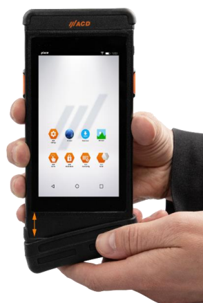
Abb. 35: Untere Logistikschutzkappe anbringen
