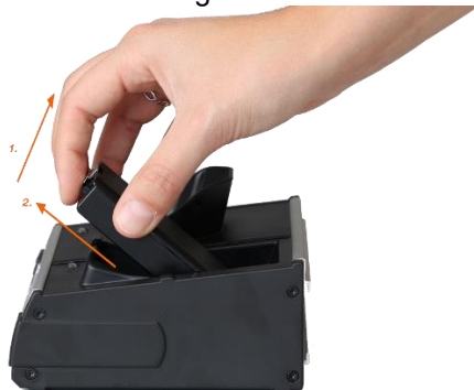
Abbildung 13: Ersatzakku aus der Dockingstation entnehmen
