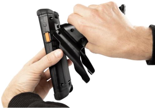
Abb. 30: M2Griff5/M2Griff5 SE ans M2Smart®SE anbringen
