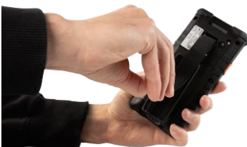
Abb. 8: Klettverschluss des Haltebandes schließen
