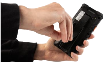
Abbildung 9: Klettverschluss des Haltebandes schließen
