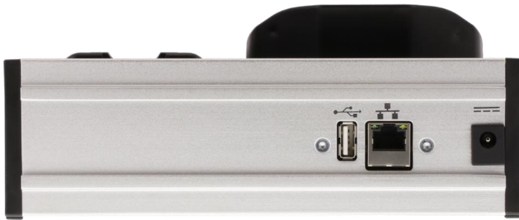
Abb. 17: Schnittstellen der DS2Smart ® Lade- und Übertragungsbox
