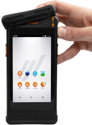
Abb. 36: Obere Logistikschutzkappe abnehmen
