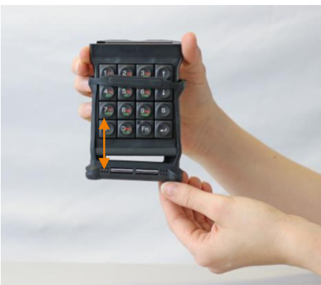
Abb. 40: M2Key16 Logistik Schutzkappe abnehmen
