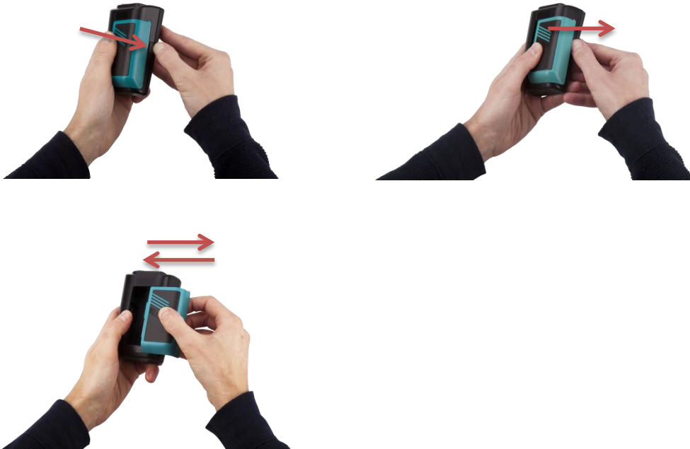
Fig. 11: remplacement de la batterie
