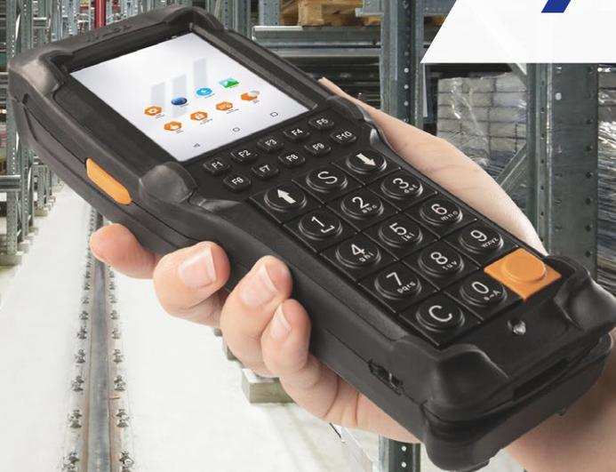
M270SE avec ou sans poignée et différentes variantes d'imageurs pour une manipulation flexible
