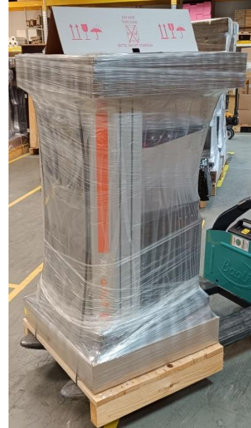
Abbildung 8: MAX BE mit Folie einwickeln
