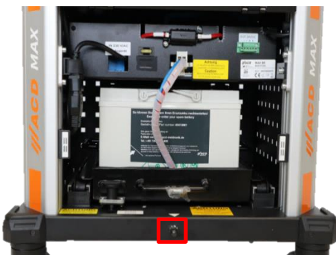
Abbildung 21: Index am Mobilem Arbeitsplatz für Batteriewechsel an der MAX Powerstation
