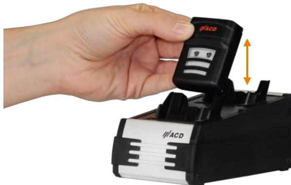
Abbildung 3: Handrückenscanner in die Dockingstation einlegen und entnehmen
