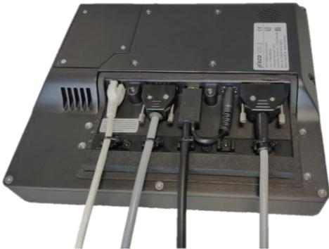
Die Schnittstellenabdeckung ist mit vier Innensechskantschrauben M6 x 16 mm mit einem Drehmoment von 1,0 Nm zu verschrauben.
