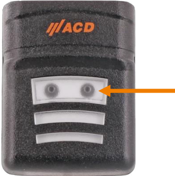
Figura 1: Encender el escáner de mano
