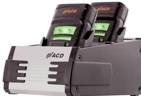
Figura 8: LED de estado del HasciSE (2/2)
