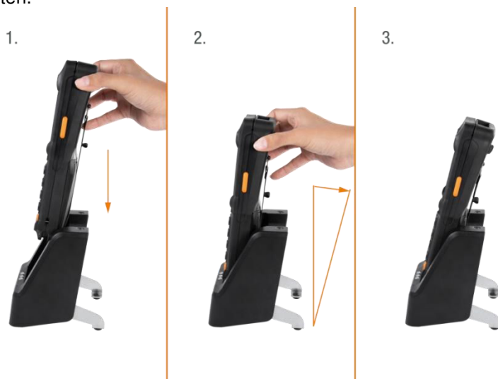
Abb. 2: Mobilen Handheld Computer in die Dockingstation einlegen
