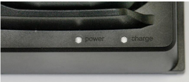
Abb. 7: Status LEDs des Ersatzakkus
