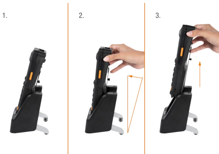
Abb. 3: Mobilen Handheld Computer aus der Dockingstation entnehmen
