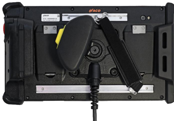
Abbildung 4: Ansicht Rückseite mit Zustimmtaster
