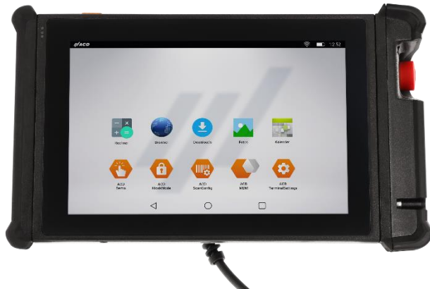
Abbildung 3: Frontansicht mit Not-Halt Taster
